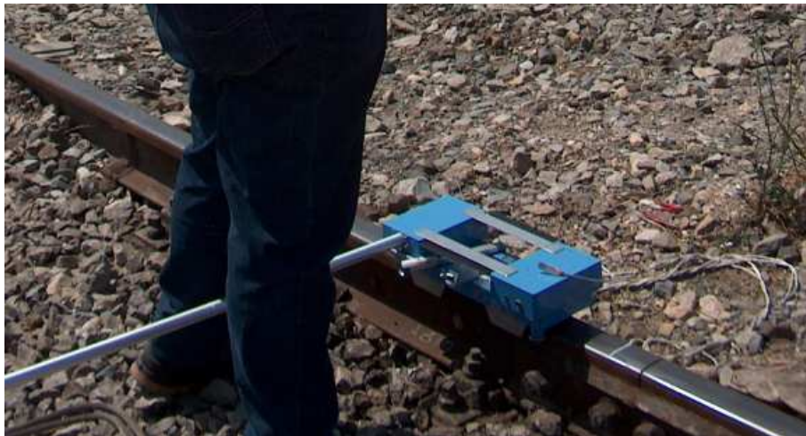
Figura 4. Particolare dell'apparato di misura CAT.
